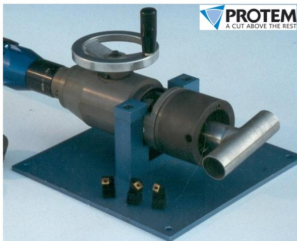
As maquinas de faceio e bisel Protem serie SE são leves e portáteis. Elas vão a usinar na maioria de tubos metálicos inclusive de aço inox de 10 ate 120 mm de diâmetro externo.
